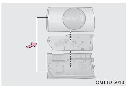
Шаг 2. С помощью плоской отвертки, обернутой изоляционной лентой, снимите сначала крышку пульта, а затем — печатную плату.
