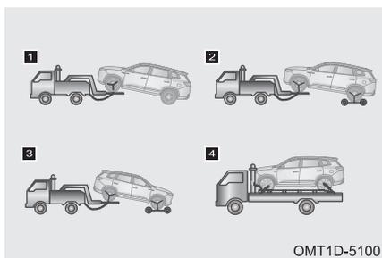
**1** Буксировка с вывешиванием передних колес (для переднеприводных автомобилей). Убедитесь, что буксируемый автомобиль надежно зафиксирован на эвакуаторе.
