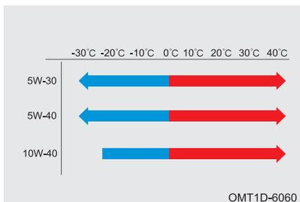
В зависимости от температуры воздуха в месте эксплуатации автомобиля выбирайте масло соответствующего класса качества и вязкости, как указано в приведенной выше таблице.
