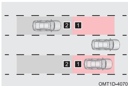
Система BSD активируется, когда скорость автомобиля превысит 15 км/ч. При замедлении автомобиля в интервале скоростей от 15 до 10 км/ч система BSD переходит в режим ожидания.
