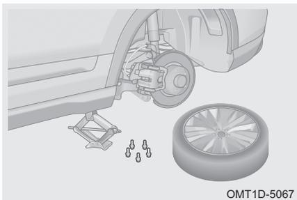
Шаг 5. Отверните колесные болты, вращая баллонный ключ против часовой стрелки, и снимите поврежденное колесо.
