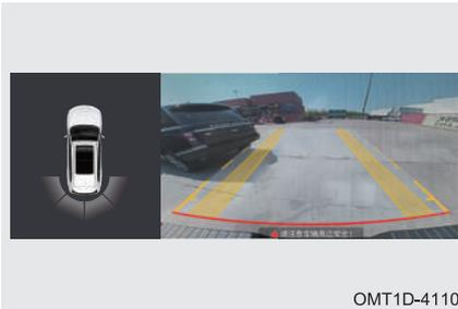
Чтобы вывести на дисплей монитор заднего обзора и линии прогнозируемой траектории, переведите рычаг селектора в положение R (задний ход). Линии прогнозируемой траектории изменяются в зависимости от угла поворота рулевого колеса.
