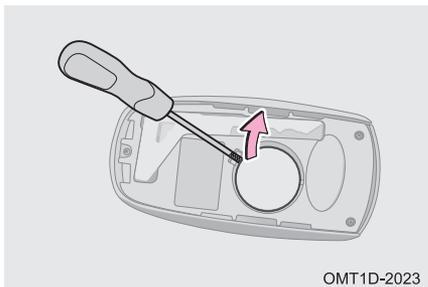
Шаг 2. С помощью плоской отвертки, обернутой изоляционной лентой, извлеките разряженный элемент питания из печатной платы и установите новый элемент питания так, чтобы сторона со знаком (+) была направлена вверх.
