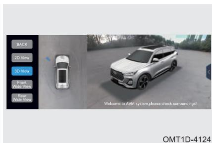
Включите монитор кругового обзора. Нажмите кнопку широкоугольного вида спереди/сзади для вывода на экран широкоугольного вида спереди/сзади.
