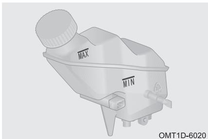
Уровень жидкости должен находиться между отметками MIN и MAX на корпусе бачка главного тормозного цилиндра. Если уровень тормозной жидкости опустился до отметки MIN или ниже ее, долейте тормозной жидкости в бачок и незамедлительно обратитесь на сервисную станцию официального дилера Chery для проверки и ремонта автомобиля.
