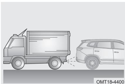
Если рядом с автомобилем имеются источники ультразвукового излучения, например, звуковые сигналы других автомобилей, двигатели мотоциклов или раздается звук торможения тяжелых транспортных средств.
