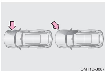
Боковые подушки безопасности и оконные шторки безопасности могут не сработать при столкновении с ударом сбоку, но не в область салона, или с ударом сбоку под определенным углом к кузову.
