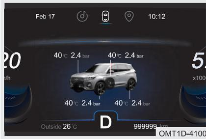
При выведенном на дисплей экране информации о вождении автомобиля вы можете кнопкой управления на рулевом колесе **OK** перелистывать экраны давления воздуха в шинах и температуры шин.
