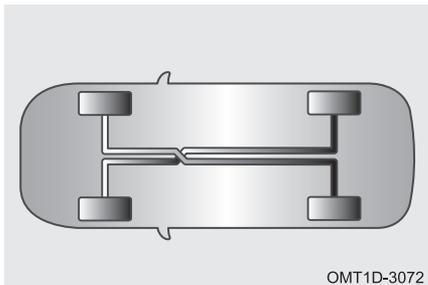
Данный автомобиль имеет двухконтурную тормозную систему, состоящую из двух независимых контуров. В случае отказа одного из контуров работоспособность тормозной системы обеспечит второй контур. Но при этом водителю придется нажимать педаль тормоза сильнее, чем обычно, тормозной путь автомобиля увеличится и будет гореть сигнализатор неисправности тормозной системы.
