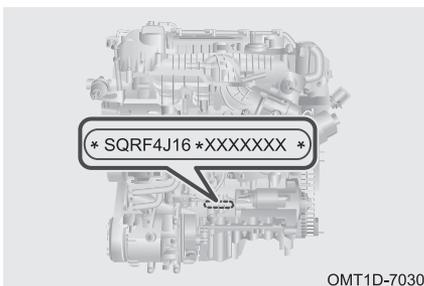
Номер двигателя выбит на блоке цилиндров, как показано на рисунке.
