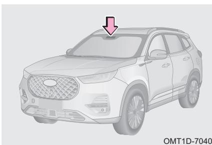
Окно устройства для радиочастотной идентификации автомобиля расположено в верхней части ветрового стекла. Само устройство находится с внутренней стороны ветрового стекла в корпусе зеркала заднего вида.
