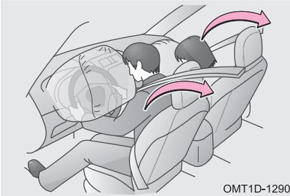
1. Совместное применение подушек безопасности и преднатяжителей ремней безопасности способствует снижению тяжести последствий при серьезном дорожно-транспортном происшествии.
