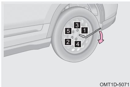
Шаг 4. Затяните болты баллонным ключом в последовательности, показанной на рисунке. Повторите данную процедуру 2 или 3 раза для надежной затяжки болтов.
