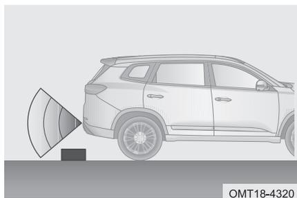
Ультразвуковые датчики не способны обнаружить низкие объекты, например, камни и т. п.
