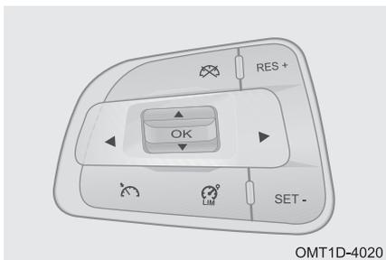
Кнопка включения и выключения системы круиз-контроля
