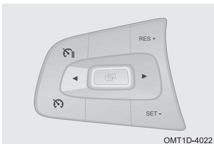
Кнопка включения и выключения системы круиз-контроля
