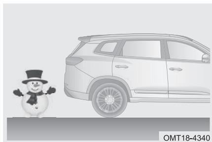
Ультразвуковые датчики не способны обнаружить объекты, которые легко поглощают ультразвуковые волны, например, рыхлый снег, вата, поролон и т. п.
