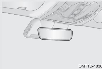
Если при движении автомобиля в темное время суток датчик освещенности, встроенный во внутреннее зеркало заднего вида, обнаружит свет фар движущегося сзади транспортного средства, то отражающая способность зеркала будет автоматически снижена, чтобы защитить водителя от ослепления отраженным светом фар.
