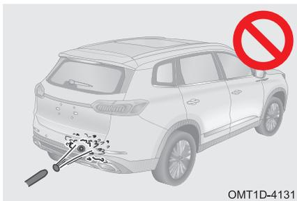
Для нормальной работы системы помощи при парковке поверхность датчиков следует регулярно очищать от снега, грязи пыли. Пользуйтесь для этого мягкой тканью или струей воды под низким давлением.
