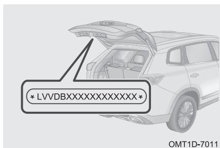
Идентификационный номер автомобиля (VIN) нанесен на дверь багажного отделения, как показано на иллюстрации.
