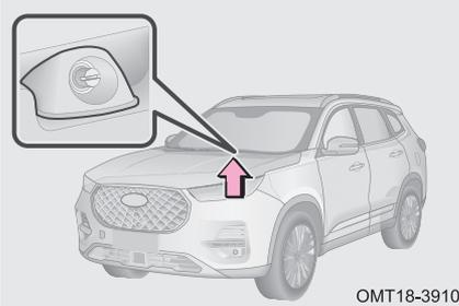
Форсунки омывателя ветрового стекла расположены на панели под ветровым стеклом.
