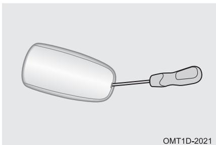
Шаг 1. С помощью плоской отвертки, обернутой изоляционной лентой, снимите сначала крышку пульта, а затем — печатную плату.
