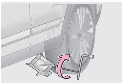
Шаг 4. Как только головка домкрата коснется опорной площадки на кузове, установите рукоятку домкрата на домкрат, вставьте колесный ключ в рукоятку домкрата, затем вращайте баллонный ключ по часовой стрелке, чтобы поднять автомобиль.
