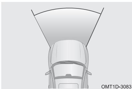
Условия срабатывания. Как правило, в случае фронтального столкновения подушки безопасности водителя и переднего пассажира, а также подушка безопасности для защиты коленей водителя (для некоторых вариантов исполнения автомобиля) срабатывают, если замедление автомобиля превышает определенную величину.
