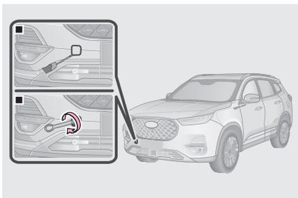
Шаг 1. С помощью плоской отвертки, обернутой изоляционной лентой, снимите декоративную крышку отверстия для буксирной проушины.
