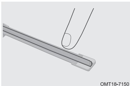
Проверьте состояние рабочей кромки щетки очистителя ветрового стекла, проведя по ней пальцем. Неровная поверхность резиновой ленты уменьшает эффективность работы очистителя.
