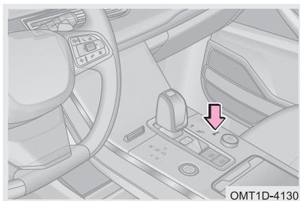
Для включения системы сигнализации при парковке нажмите выключатель **P** (при этом загорится встроенный в клавишу выключателя индикатор). Если рычаг селектора не находится в положении R (задний ход), нажмите выключатель **P** еще раз, чтобы выключить систему сигнализации при парковке.
